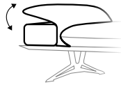
ARMLEHNE C ARMREST C Aufgelegtes Kissen mit Raster-Funktion Overlaid cushion with rat- chet function
